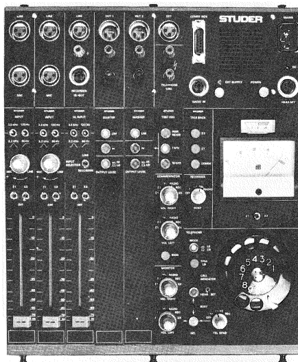
Studer 069, Reportageeinheit für Rundfunkübertragungen «im Felde» via Telefonleitungen.
